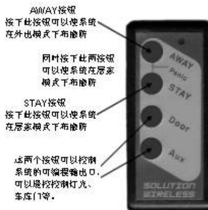
图 2: RE013 4 键无线遥控器
